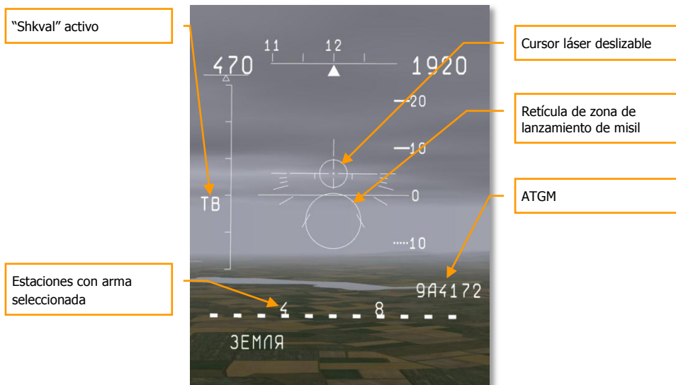
Figura 29: HUD con el Sistema de Designación de Objetivos "Shkval" o "Mercury"
