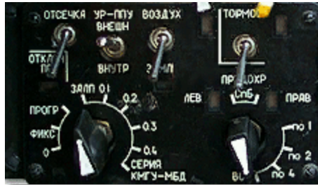
Figura 19: Panel de Control del Sistema de Armamento del Su-25T
