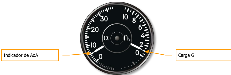
Figura 9: Indicador de AOA y Acelerómetro
